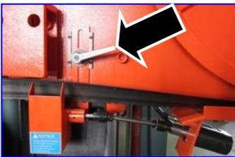
Paso 8: Afloje los insertos de carburo izquierdo y derecho. Separe la cuchilla vieja de debajo del asiento de la guía izquierda y derecha y luego saque toda la cuchilla.
