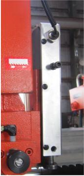
Este dispositivo detecta la desviación de la cuchilla. Si la cuchilla se desvía más allá del rango preestablecido, la máquina se detendrá automáticamente. Cuando este dispositivo está instalado, el ancho de corte se reducirá. El valor detectado de desviación de la cuchilla y los valores preestablecidos se muestran en la pantalla del panel de control.
