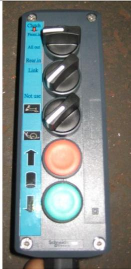
Con este mando a distancia, puede elegir entre accionar la mesa de rodillos de forma independiente o sincronizar los rodillos con el movimiento de los tornillos de banco. Puede utilizar el mando a distancia para alimentar el material tanto hacia adelante como hacia atrás. El interruptor de selección de la velocidad de avance también permite a los usuarios alimentar rápidamente y con precisión las piezas de trabajo a la zona de corte.
