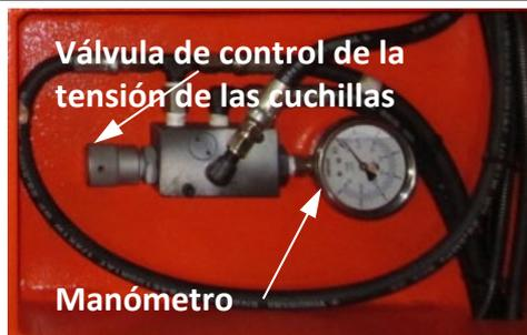
Esta válvula de control de presión ajusta la tensión de la cuchilla. La presión de la cuchilla se ajusta normalmente entre 45 y 50 kg/cm<sup>2</sup> dependiendo de las condiciones de corte.
