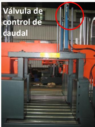
El dispositivo de pinza superior se utiliza para el corte de paquetes y se compone de dos pinzas que se instalan en la parte superior de los tornillos de banco delanteros y traseros, respectivamente.
