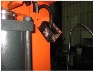
Active el interruptor para proyectar un haz de luz sobre la pieza de trabajo. El operario puede utilizar la luz como referencia para ajustar la dimensión de corte de la pieza. La luz se apagará automáticamente en 90 segundos.
