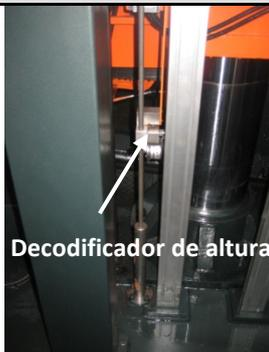
Con este dispositivo opcional, el operario puede introducir el ancho de la pieza a través del panel táctil HMI. Cuando se inicia el corte y la cuchilla comienza a descender, el panel mostrará la altura actual de la cuchilla, la velocidad de descenso de la cuchilla y la velocidad de corte calculada por el sistema.
