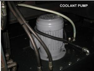
La bomba de refrigerante suministra refrigerante para reducir la temperatura en la zona de corte. También puede funcionar de forma independiente desde el panel de control y funciona con una manguera de limpieza para la limpieza de la máquina.
