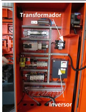
Este inversor se instala dentro de la base de la máquina. Se utiliza para controlar y estabilizar la velocidad de la hoja de sierra durante el corte. Para ajustar la velocidad de las cuchillas, utilice el botón giratorio de control de velocidad en el panel de control.
