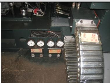
Estos reguladores controlan la presión de sujeción de los tornillos de banco y las pinzas superiores. Al cortar tubos o materiales más blandos, es necesario ajustar la presión de sujeción de los tornillos de banco y las pinzas superiores para evitar daños en la superficie del material. Ajuste la presión de sujeción según el material que corte.
