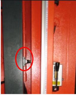
El soporte situado en el lateral del eje principal activa el interruptor central de fin de carrera mientras la cuchilla está en marcha. En este momento, el brazo guía no se puede mover y el tornillo de banco delantero se puede abrir poco a poco.
