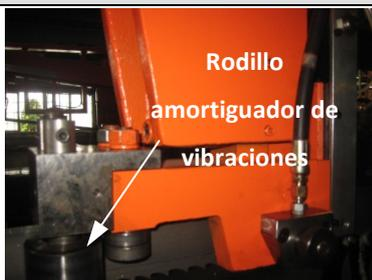
El rodillo amortiguador de vibraciones está instalado en el brazo izquierdo de la sierra. Reduce el ruido de alta frecuencia durante el corte de piezas grandes.
