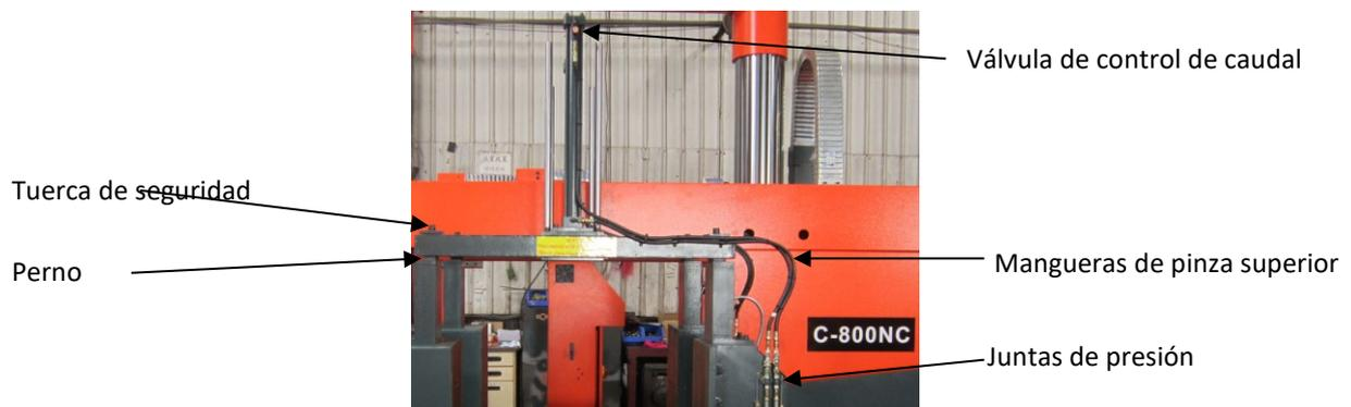
Paso 2: Conecte las mangueras de la pinza superior a las juntas de presión de los cilindros hidráulicos del tornillo de banco.
