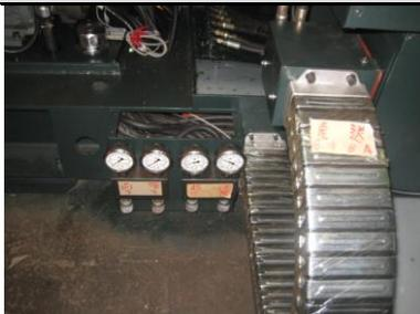
Beim Sägen von Rohren oder im Fall von weicheren Bauteilmaterialien ist der Klemmdruck von Spannstock und oberer Klemme vorab anzupassen, ansonsten können die Oberflächen beschädigt werden. Einzelheiten richten sich nach dem Material selbst.
