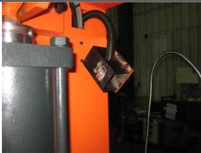
Per Schalter kann ein Lichtstrahl auf das Werkstück gerichtet werden, der hilfreich sein kann, um die Schnittposition festzulegen. Nach 90 Sekunden schaltet sich das Licht selbsttätig ab.
