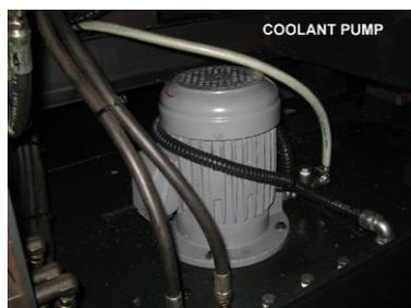
Wenn das Hydrauliksystem eingeschaltet ist, kann die Kühlmittelpumpe eigenständig vom Kontrollfeld aus bedient werden. Kühlmittel kann verwendet werden, um Späne abzuwaschen und auch um während des Sägens für Kühlung zu sorgen.
