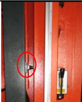
Der Winkel seitlich an der Hauptwelle wirkt auf den mittleren Grenzscharter ein, während das Sägeband läuft. In diesem Zustand kann der Führungsarm nicht verstellt werden; der vordere Spannstock lässt sich nur in kleinen Schritten öffnen.
