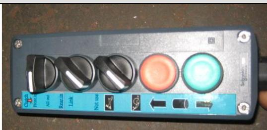
Gerade im Zusammenspiel mit dieser Fernsteuerung erweist sich die Rollenbahn als besonders praktisch. Die Steuerung kann unabhängig oder synchronisiert mit den Schraubstöcken erfolgen, Vorwärts- und Rückwärtsfahrt sind möglich. Auch die Geschwindigkeit lässt sich regeln.
