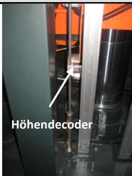
Bei Verwendung dieser Zusatzkomponente lässt sich die Bauteilhöhe über das Bedienpult eintragen. Nach dem Beginn der Arbeit wird dann die Höhe des Sägebands ständig mitverfolgt und angezeigt. Weiterhin errechnet das System auf dieser Grundlage Absenkgeschwindigkeit und Schneidrate.
