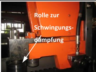
Die Schwingungsdämpferrolle, installiert links am Sägearm, senkt den Geräuschpegel beim Sägen großer Bauteile.
