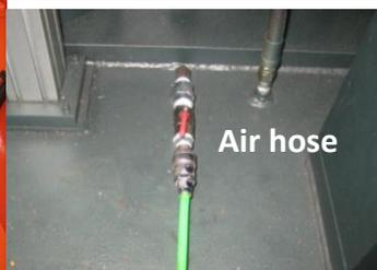
Dieses Zubehörteil erzeugt, sobald es über das Bedienpult aktiviert wird, in regelmäßigen Zeitabständen einen Ölnebel, um Späne vom Sägeband zu beseitigen. Beim Sägen von Aluminium ist dies erforderlich.
