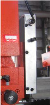
Entsprechend ausgestattet, überwacht das System selbsttätig die Abweichung des Sägebandes und schaltet sich bei Überschreiten einer voreingestellten Toleranz ab. Auf diese Weise wird die Schnittbreite begrenzt. Sollwert und aktueller Messwert werden fortlaufend auf dem Bildschirm angezeigt.
