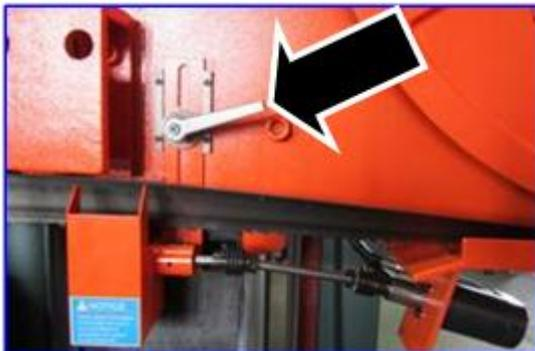
Schritt 8 - Linke und rechte Bandführung lösen, mit den Hebeln wie auf dem Bild gezeigt.
