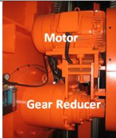
Dieses speziell entworfene Untersetzungsgetriebe kann auf Ihre voreingestellte Sägebandgeschwindigkeit und Drehmoment arbeiten.
