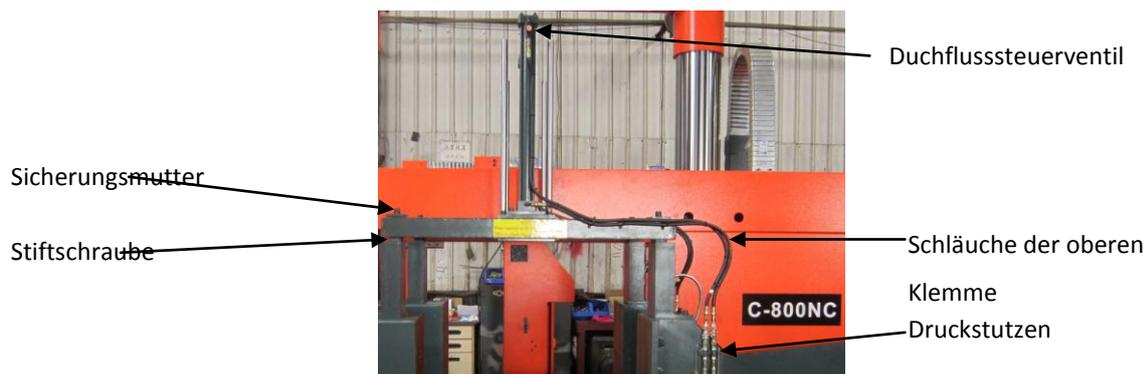
Schritt 2 - Verbinden Sie die oberen Klemmschläuche mit den Druckstutzen auf den Spannstöcken-Hydraulikzylindern.
